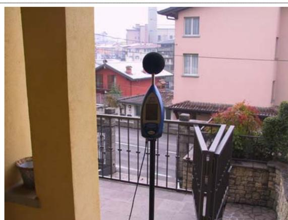
Foto 2: misura n. 2, rilievo da 24 ore in Via Roma n. 54
